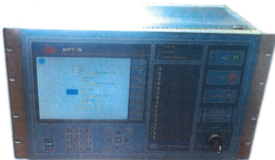
Рис. 5.1. Внешний вид контроллера (крейт 14 слотов).
